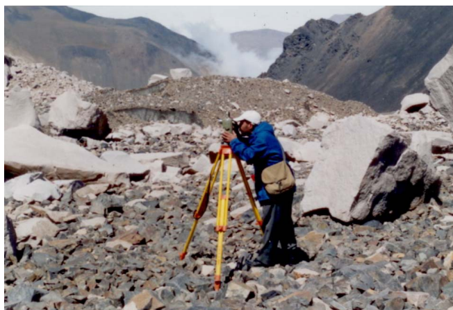
شکل ۹. اندازه‌گیری در امتداد مقاطع با دوربین تئودولیت T-16
