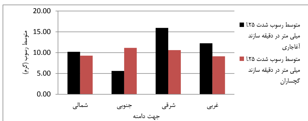
شکل ۸. مقایسه رسوب تولیدی در شدت ۱/۲۵ میلی‌متر در دقیقه در سازندهای گچساران و آغاچاری
