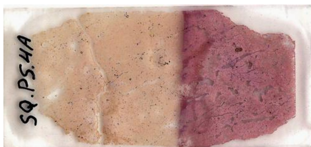
شکل ۶. نمای کلی از مقطع نازک بیانگر یک سنگ رسوبی ریزدانه حاوی خرده‌سنگ‌های ریز پراکنده در اندازه ماسه. رنگ قرمز در بخش رنگ‌آمیزی شده با محلول آلزارین-د-اس بیانگر ترکیب کلسیتی برای زمینه کربناتی است
