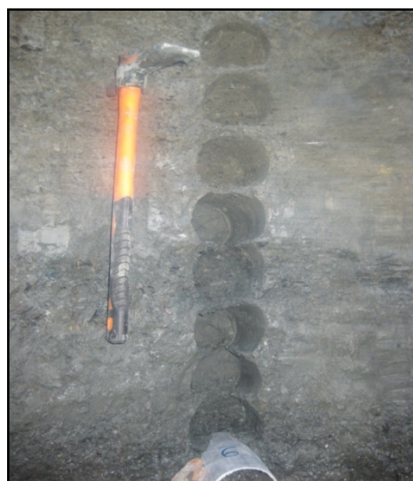
شکل ۳. برداشت نمونه‌ها از دیواره عمودی چاه به همراه مغزه ۵۰ سانتی‌متری از داخل چاه با استفاده از نمونه‌بردار پیت‌کورر روسی
