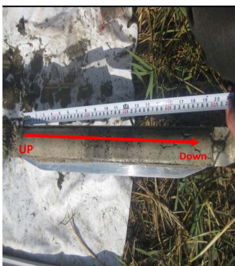
شکل ۳. برداشت نمونه‌ها از دیواره عمودی چاه به همراه مغزه ۵۰ سانتی‌متری از داخل چاه با استفاده از نمونه‌بردار پیت‌کورر روسی
