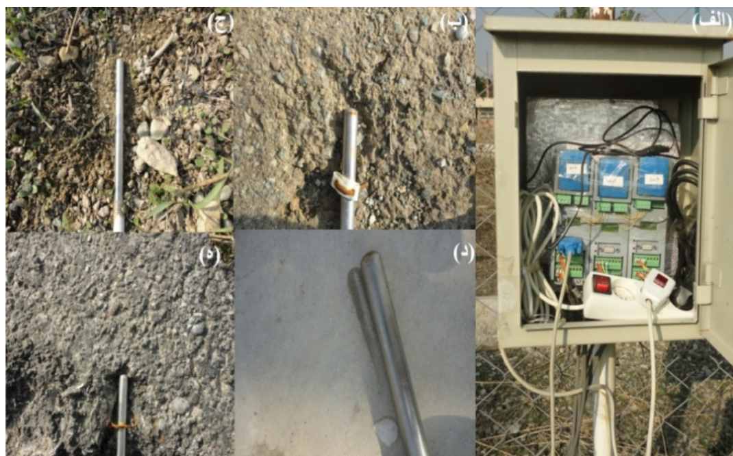
شکل ۱. ترموکوپل‌های سنجش دمای سطحی؛ الف) به‌همراه سطوح مورد مطالعه شامل: ب) سیمان، ج) خاک، د) سنگ، ه) آسفالت
