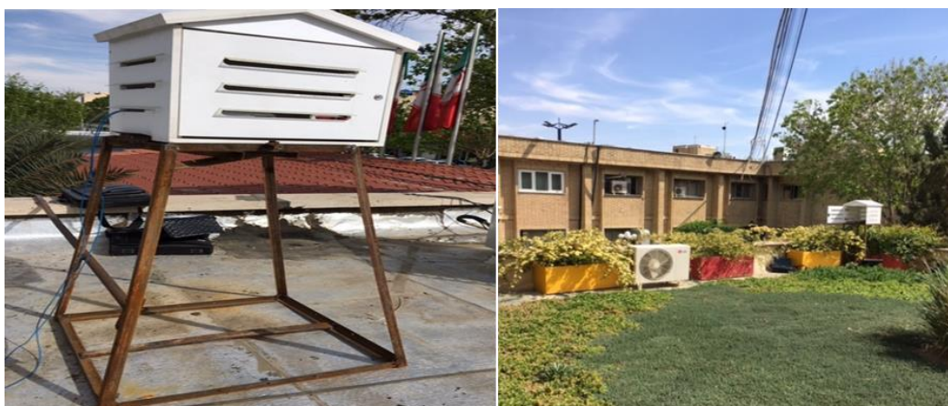
شکل ۱. نحوه نصب دیتالاگرها در یک و نیم متری بالای دو بام در خارج از جعبه اسکریبن (سمت راست: بام سبز؛ سمت چپ: بام معمولی)
