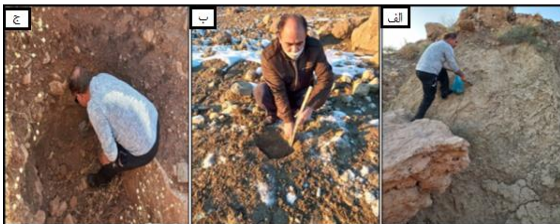
شکل ۲. تصویر الف) برداشت از لایه‌های مارن به‌صورت خشک تصویر ب) برداشت لایه‌های مارن بعد از بارش ۴۰ میلی‌متری تصویر ج) برداشت مواد آبرفتی از طریق حفر چاهک
