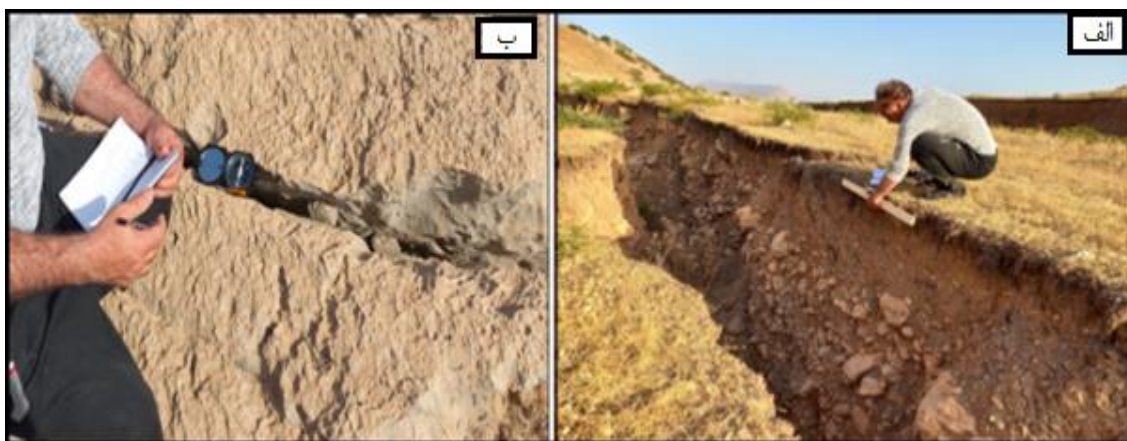
شکل ۱. تصویر الف) اندازه‌گیری گسیختگی‌های اصلی زمین‌لغزش اخیر تصویر ب) درز و شکاف‌های سنگ‌های آهکی
